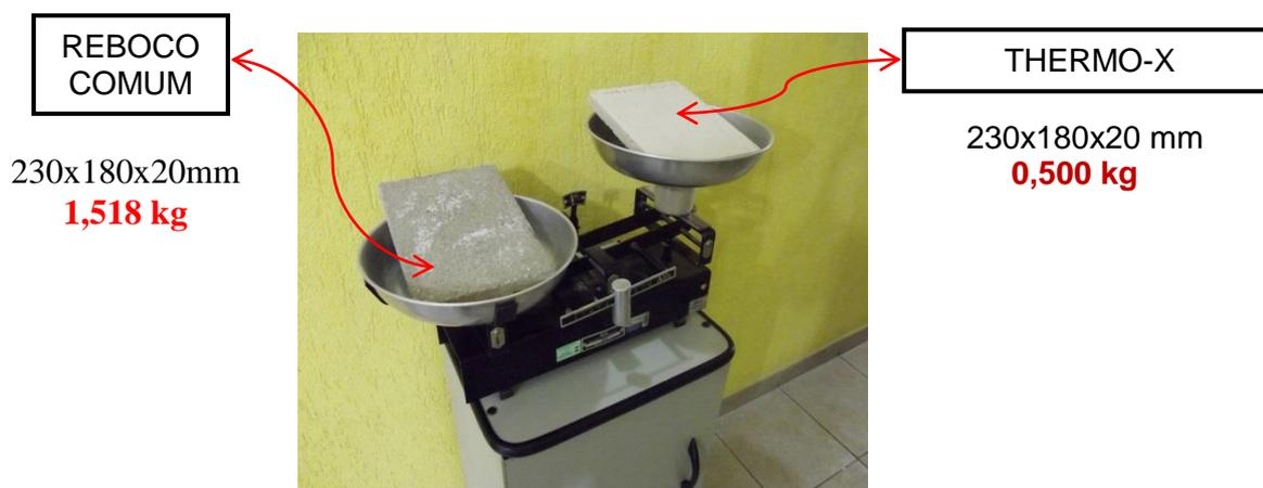
**Thermo-x** – 12kg/m<sup>2</sup> com 2cm de espessura
