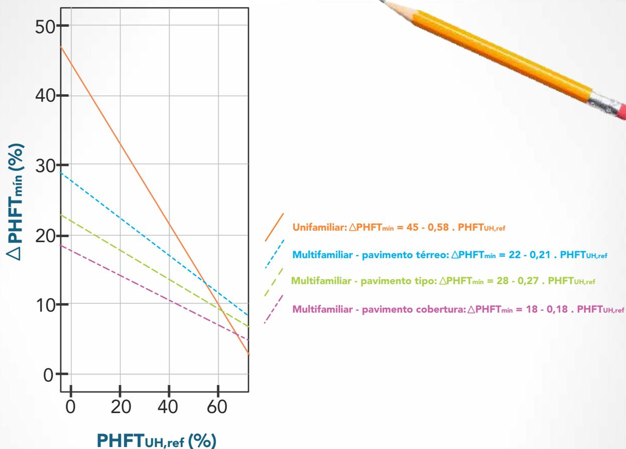
Figura 4 - Àbaco e equações para a obtenção do  $\Delta PHFT_{\min}$  quando o  $PHFT_{UH,ref}$  for inferior a 70%
